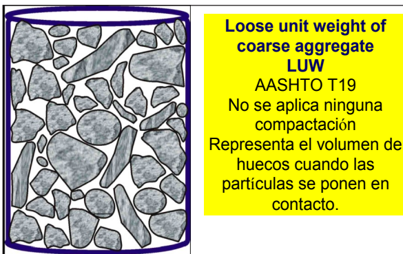
Figura 2. Esquema de la densidad aparente sin compactar LUW .
