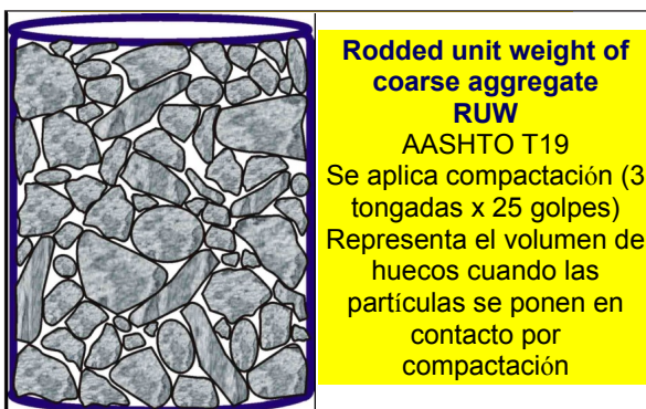
Figura 3. Esquema de la densidad aparente compactada RUW .
