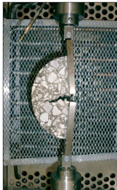
Figura 1: Ensayo Fénix.
