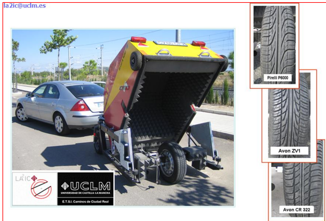
Figura 5. TireSonicMk4-LA 2 IC, localización de micrófonos, y neumáticos de referencia [3].
